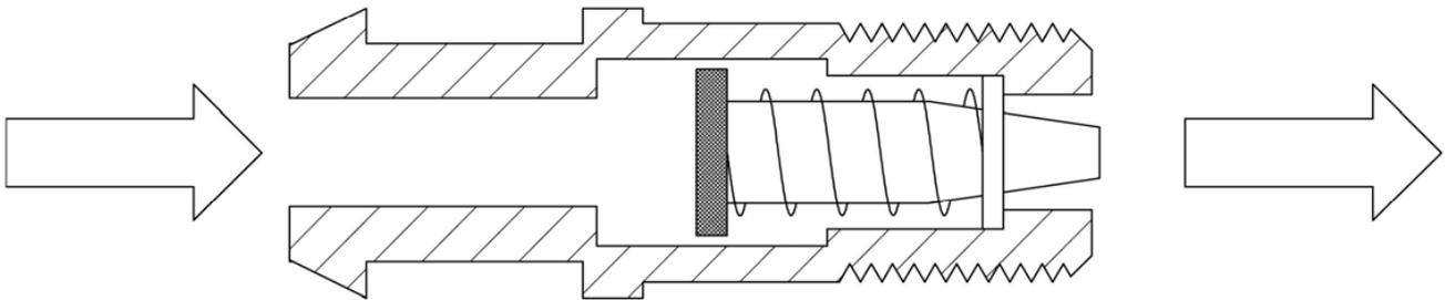
BACKFIRE — PRESSURE FROM MANIFOLD — NO FLOW
