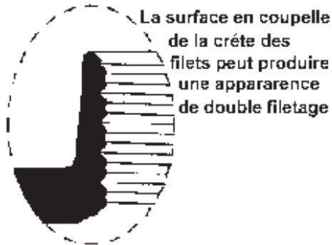
FILTAGE PRODUIT PAR FORMAGE - DÉTAIL
